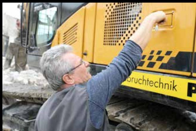
Maschinist Micha Vukasovic demonstriert, wie man die Wartungsklappen des Sany öffnet, um an die Luftfilter zu gelangen
