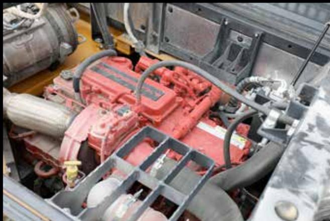
205 Kilowatt/279 PS Leistung: Cummins QSL9-6-Zylinder
