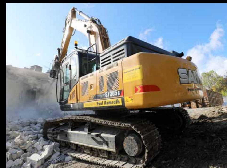
Reichweite pur: Mit seinem langen Ausleger plus FRD-Abbruchschiere reicht der SY365C 12 Meter weit
