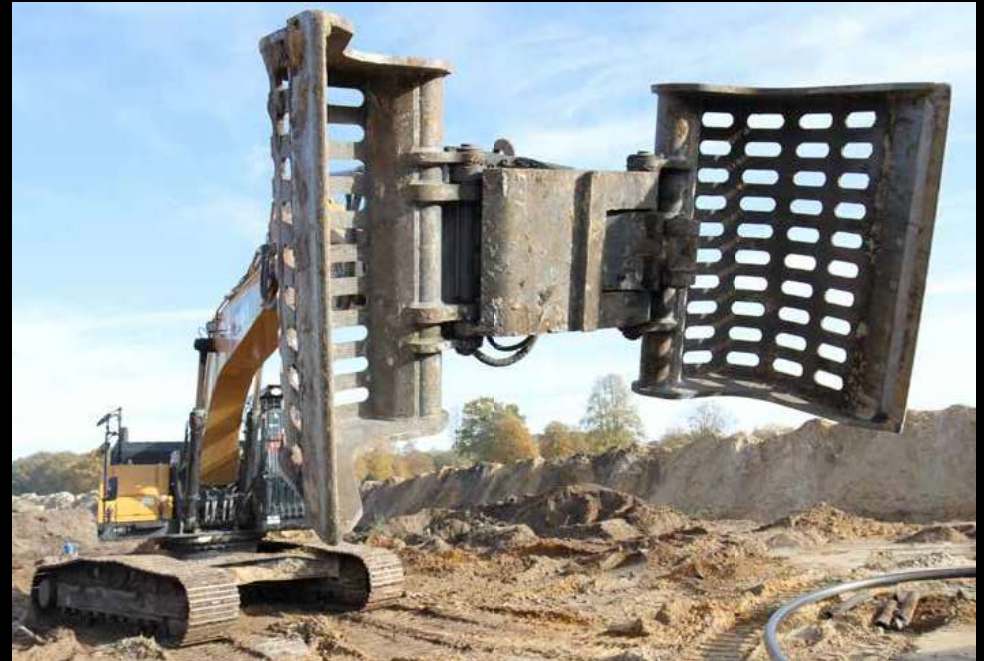
Der Betongreifer ist dank Oilquick-Schnellwechsler in Sekunden angebaut und packt am SY265C LC eisenhart zu
