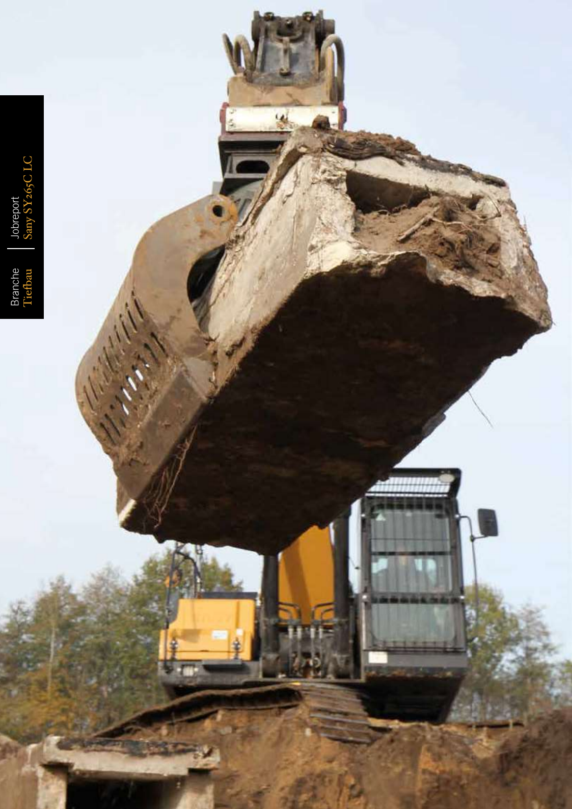
Der Betongreifer ist dank Oilquick-Schnellwechsler in Sekunden angebaut und packt am SY265C LC eisenhart zu
