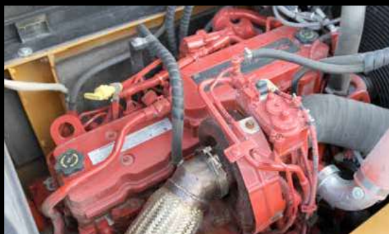
Oben: Kawasaki-Hydraulikpumpe sorgt für einen Ölfluss von 2x 246 l Rechts: Der Cummins QSB6.7 liefert eine Leistung von 142 kW/193 PS und erreicht die Abgasstufe Tier IV final
