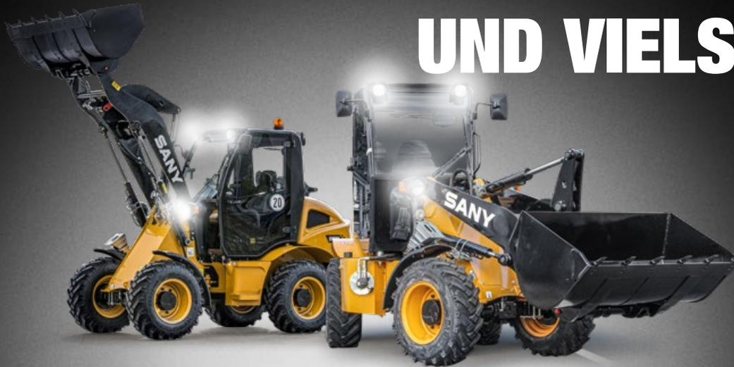
Die SANY Kompakt-Radlader SW075/ SW085 verbinden Vielseitigkeit und hohe Leistung auf ideale Weise. Mit ihrer Z-Kinematik zum schnellen Abkippen der Schaufel und kraftvollen Aufnahmen der Ladung bringen sie eine hohe Produktivität – schnell, zuverlässig und präzise bei allen Aufgaben. Zudem ist ein hydraulischer Schnellwechsler in verschiedenen Ausführungen erhältlich, das sorgt für weitere Flexibilität und Zeitersparnis.
