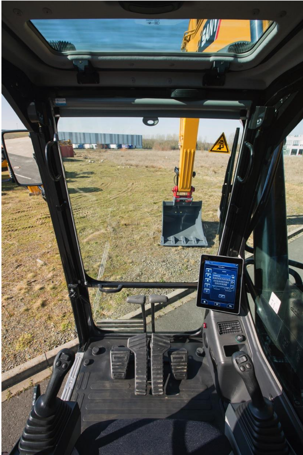
Abbildung 2: Komfortable Kabine mit hochauflösendem 10" Touchdisplay für Bilderwiedergabe und einfache Bedienung
