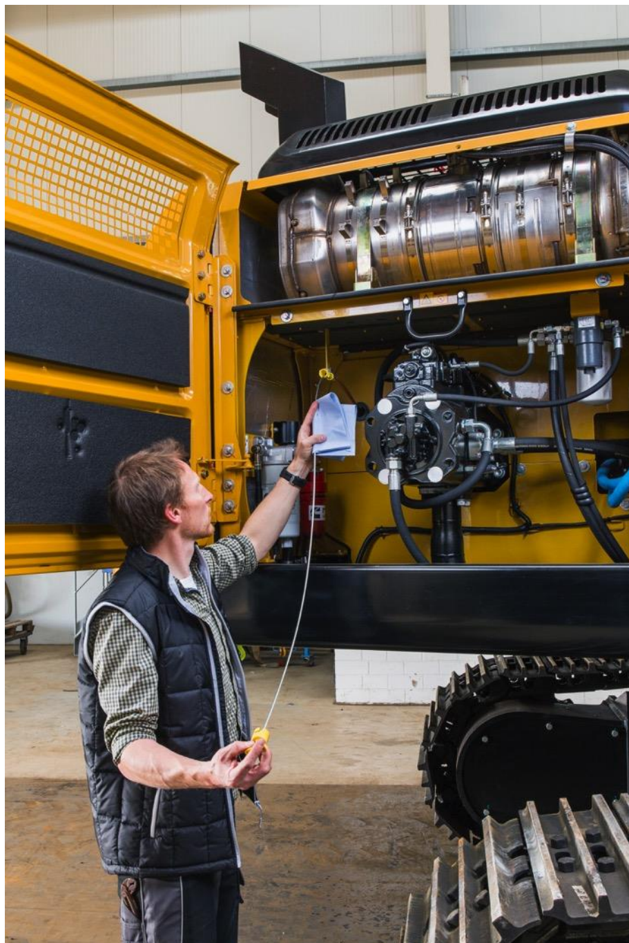
Image 2 : Bonne accessibilité pour la maintenance aux points d'entretien pertinents depuis le sol
