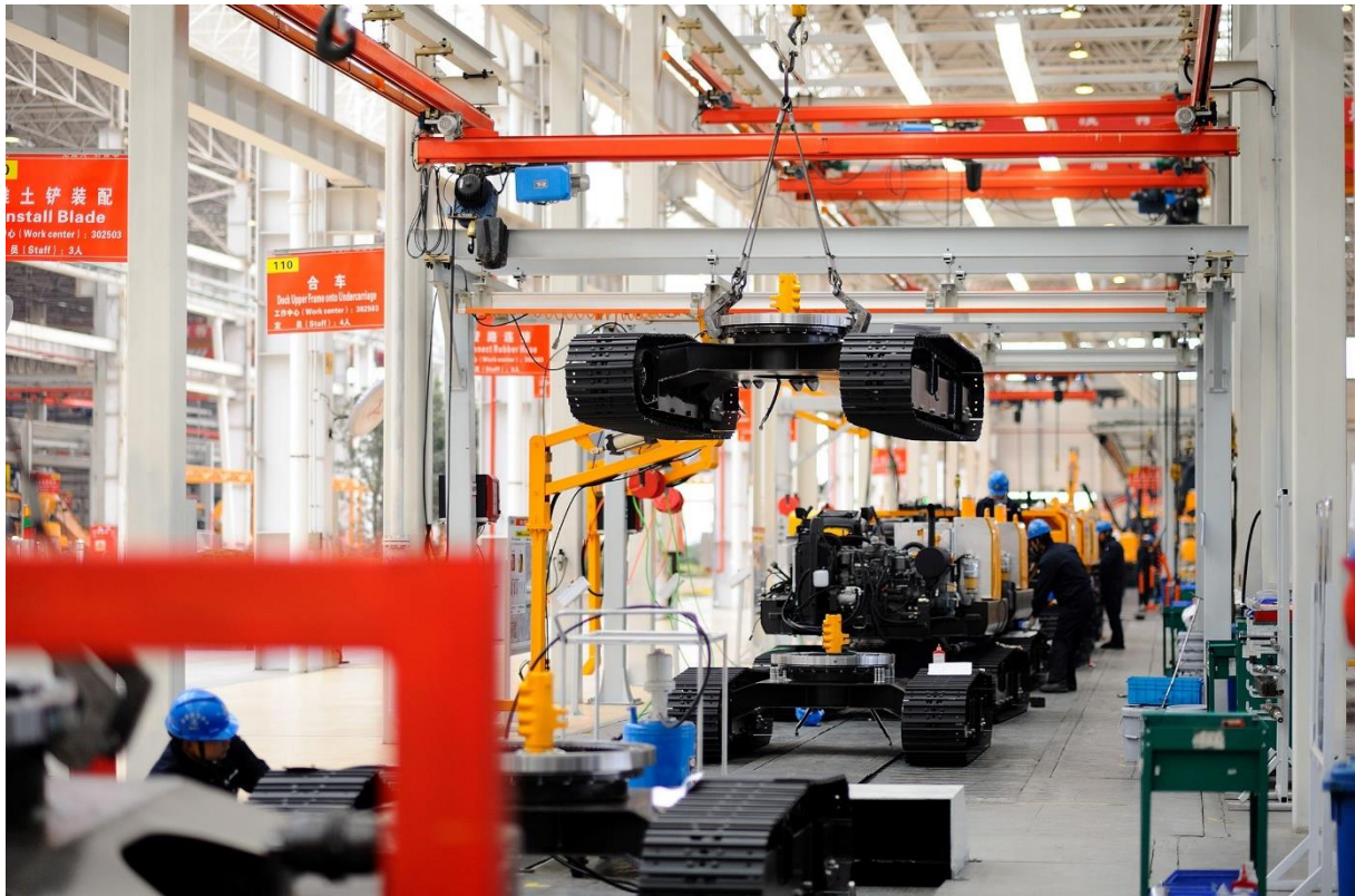
Abbildung 2: Modernste Fertigungsstraßen zur Baggermontage im Werk in Kunshan.
