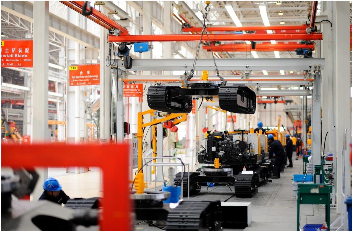
Image 2: Chaînes de fabrication modernes pour le montage des pelles excavatrices dans l'usine de Kunshan.
