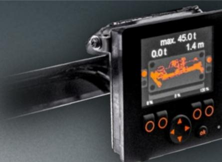
Las tres pantallas están perfectamente dispuestas para una rápida captura: La pantalla principal con todos los datos de rendimiento y de la máquina está integrada en la consola. La pantalla de visualización frontal con información de la pinza se encuentra en el borde delantero del cristal del techo, por lo que se encuentra en la línea de visión directa del conductor al colocar el spreader, y la pantalla de la cámara trasera se encuentra en el lado izquierdo de la consola.
