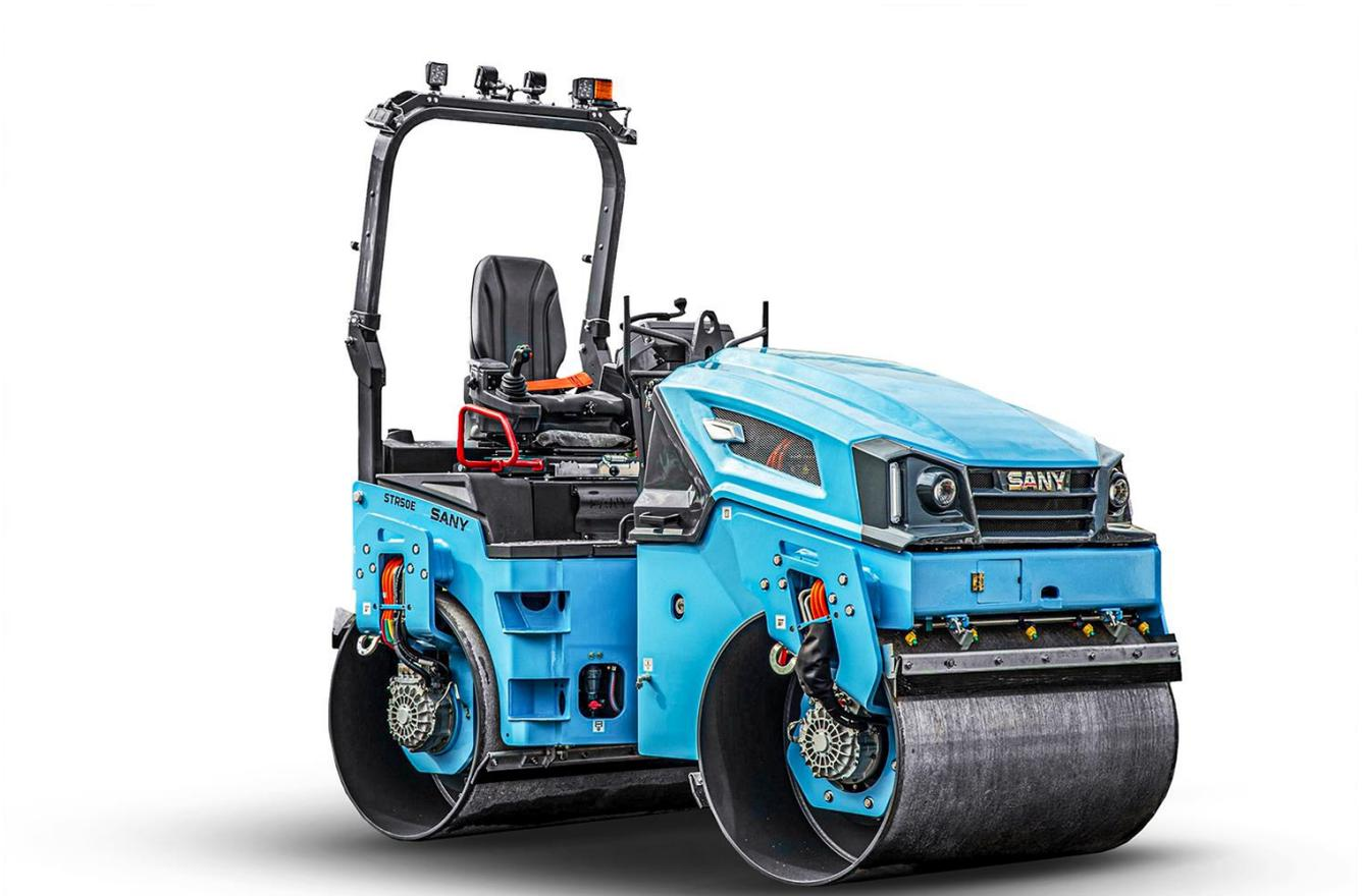
**Image 2:** *Le SANY STR50 est le premier rouleau compresseur électrique de la gamme des rouleaux tandem de 5 tonnes.*
